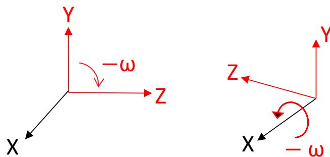
$$R_X(roll) = \begin{bmatrix} x \\ y \\ z \end{bmatrix} = \begin{bmatrix} 1 & 0 & 0 \\ 0 & \cos(roll) & -\sin(roll) \\ 0 & \sin(roll) & \cos(roll) \end{bmatrix} \begin{bmatrix} x \\ y \\ z \end{bmatrix}$$
